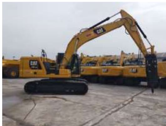
Gambar 3.33 Excavator 320 Breaker (Sumber: Dokumentasi Penulis)
