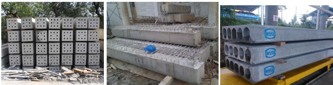
Gambar 4.14. Kolom, Balok dan Pelat hollowcore Precast
