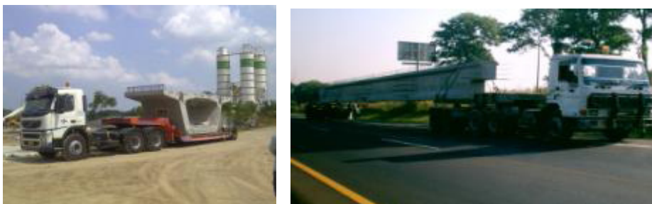
Gambar 3 Alat pengangkut “low bed” vs “boggie”
