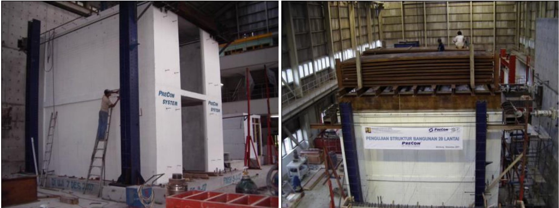
Pengujian Sistem Dinding Penumpu
