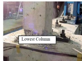
Test Shaking Table Sistem PRESSS (Maruta,Jinhua,2012) Kerusakan terpusat di komponen dissipater, jika eksternal mudah diganti
