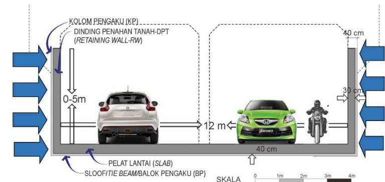
Gambar 9. Penampang konstruksi DPT/RW.
