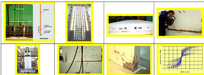
Gambar 8 Pengujian dinding tunggal geser pracetak paskatarik tanpa lekatan [17]
