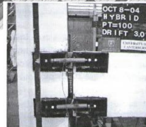
Kerusakan di alat pendisipasi energi, mudah diganti
