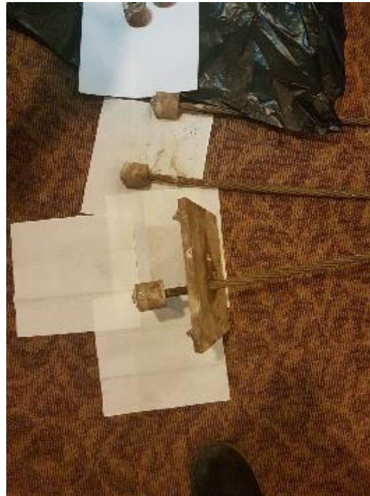
Baji digrouting di barrel
