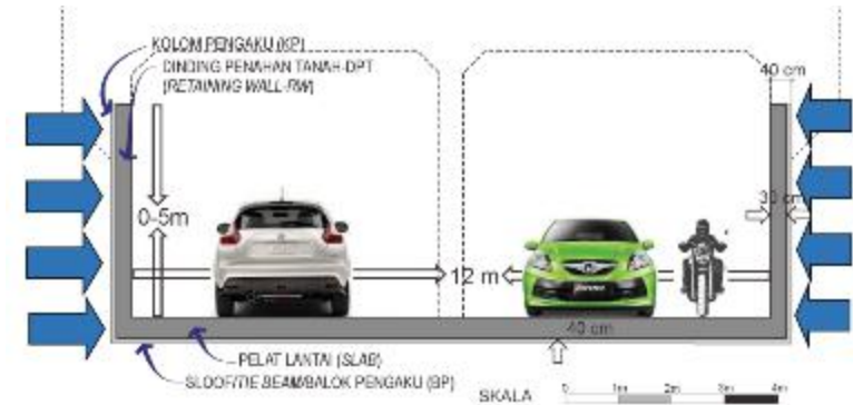
Gambar 9. Penampang konstruksi DPT/RW.
