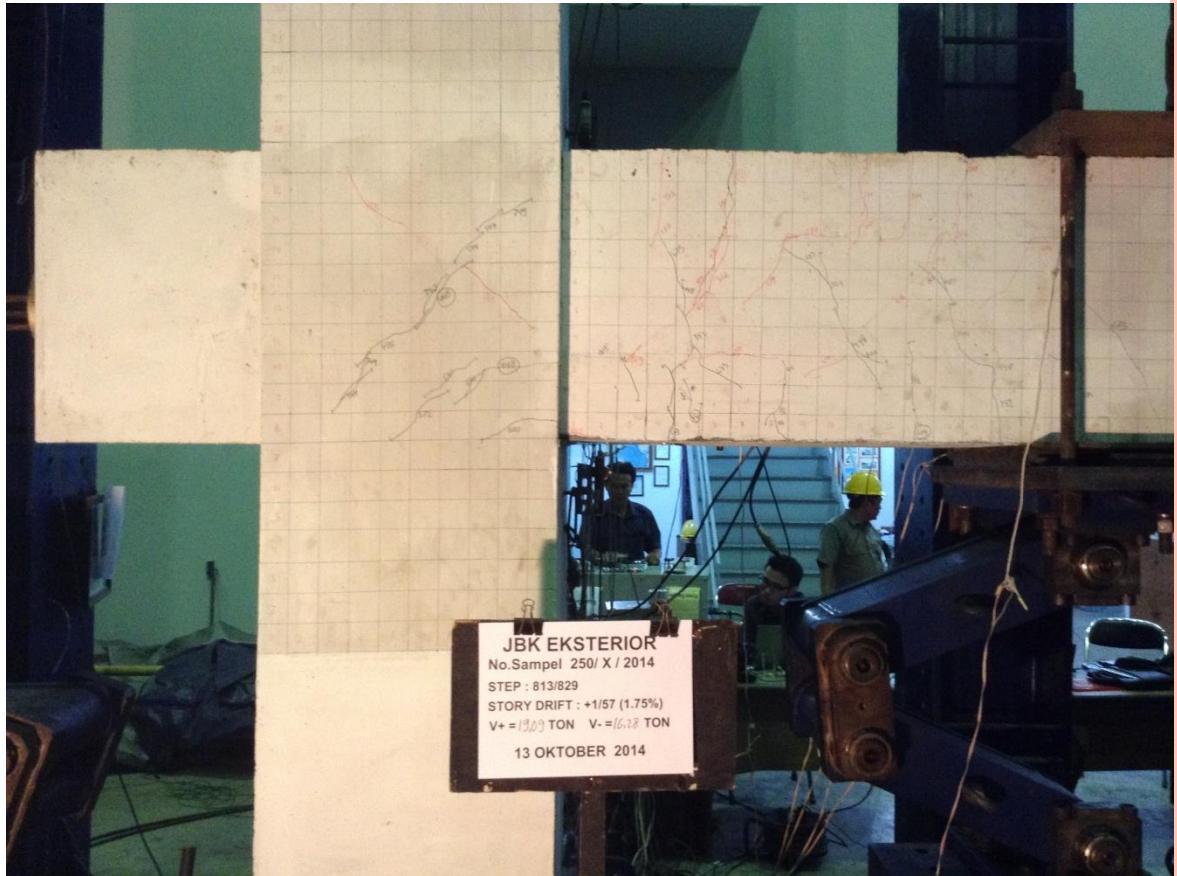
Kerusakan terkonsentrasi di dissipater. Cela dissipater membuka dan menutup selama beban bolak balik
