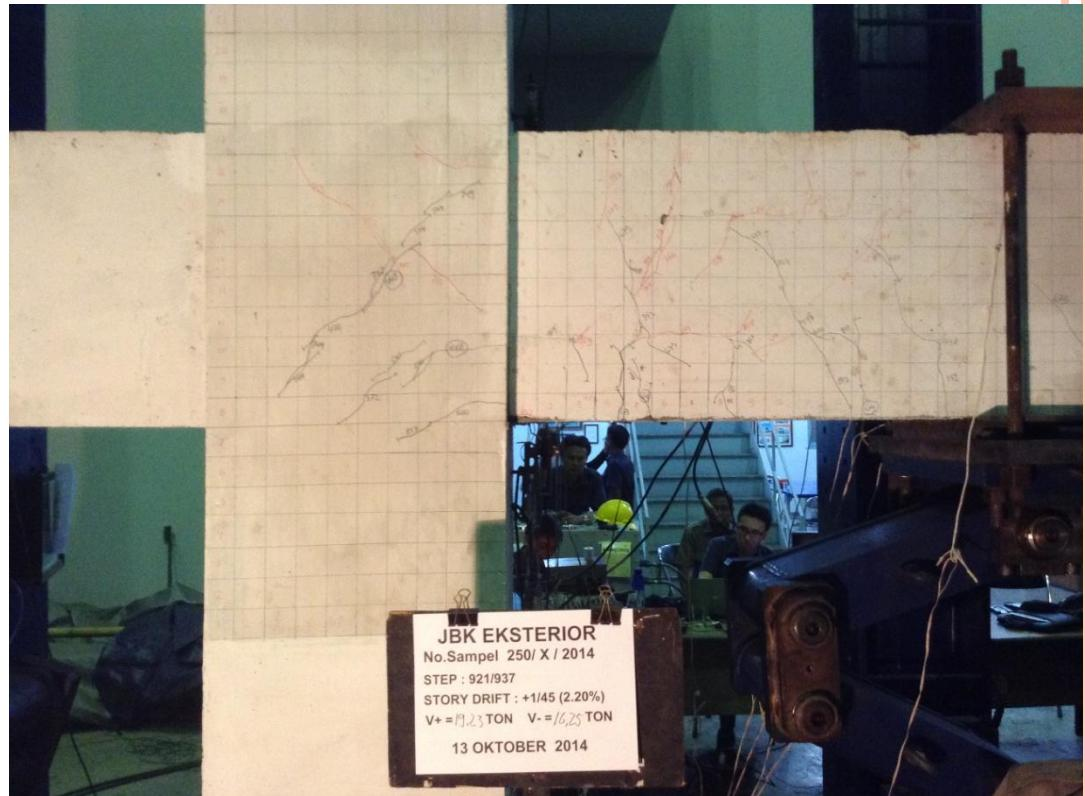
Dissipater bawah membuka dan mulai ada gap di muka kolom
