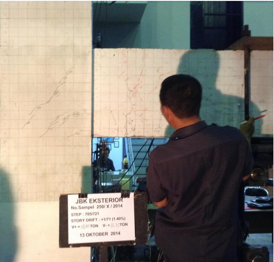
Kerusakan terkonsentrasi di dissipater. Cela dissipater membuka dan menutup selama beban bolak balik
