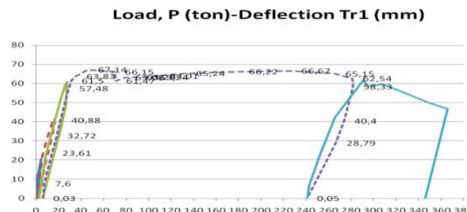
Pada sistem hybrid (50% paska tarik, 50% tulangan), Momen retak balok sistem hybrid 3.3 x momen retak balok beton bertulang (kehandalan jauh lebih baik), dan daktilitasnya pun lebih baik (137%). Hasil yang setara juga diperoleh pada balok sistem hybrid yang dibuat segmental.
