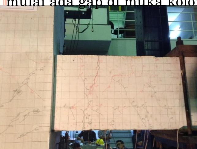
Dissipater atas membuka dan mulai ada gap di muka kolom
