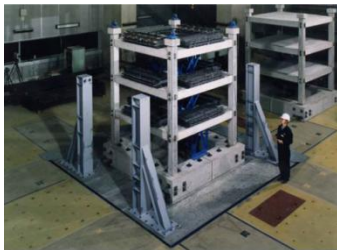
Test Pseudodynamic Sistem PRESSS dengan dissipater internal dan eksternal (Pampanin,2010)
