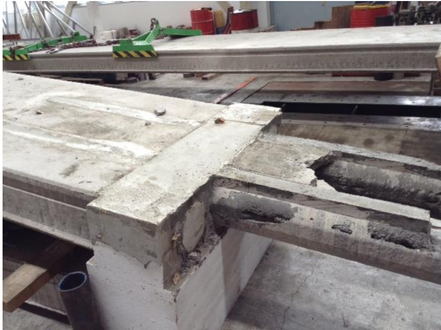
Hasil test koneksi tulangan negatif hollow core
