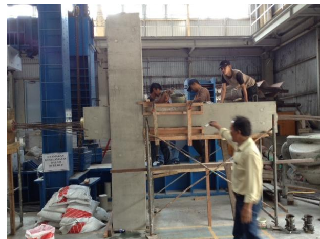
Setting up Join eksterior
