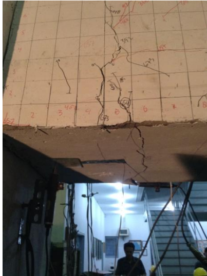
Dissipater bawah mulai membuka
