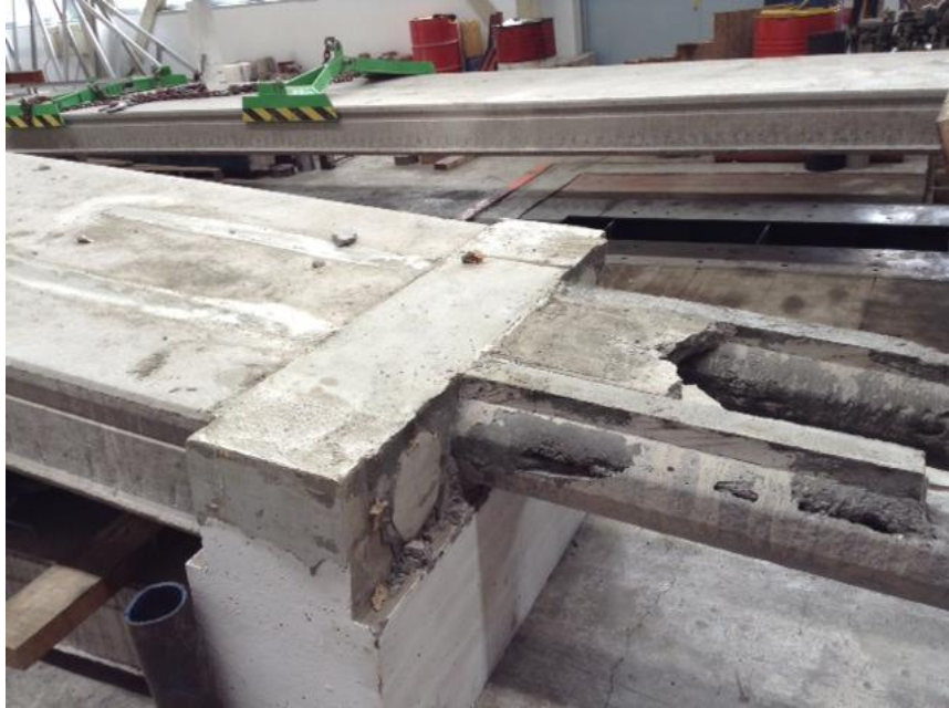
Hasil test koneksi tulangan negatif hollow core
