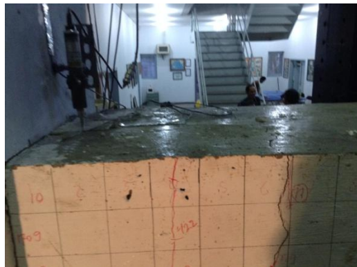
Dissipater atas mulai membuka
