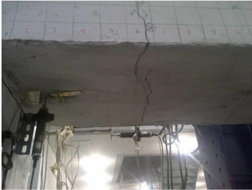
Dissipater bawah mulai membuka
