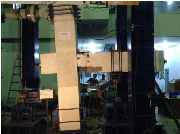
Benda uji pada drift 5%
