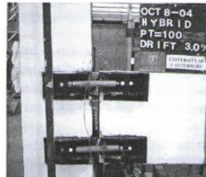
Test Pseudodynamic Sistem PRESSS dengan dissipater internal dan eksternal (Pampanin,2010)
