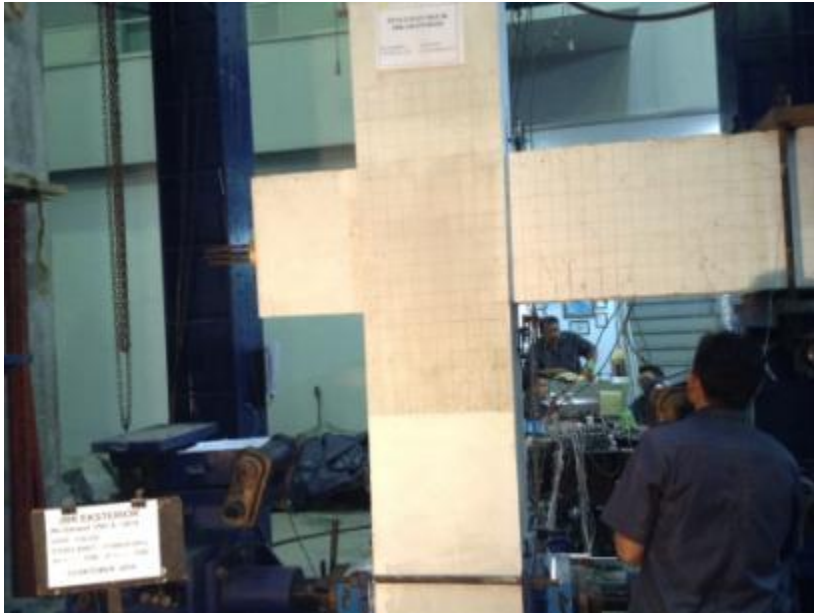
Drift 0.2% P+=7.34 ton P-=6.02 ton
