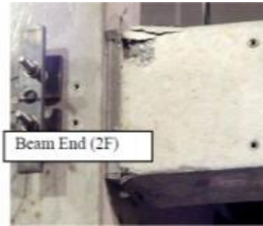
Test Shaking Table Sistem PRESSS (Maruta, Jinhua, 2012) Kerusakan terpusat di komponen dissipator, jika eksternal mudah diganti
