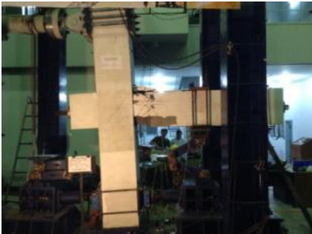
Benda uji pada drift 5%
