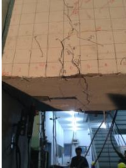
Dissipater bawah mulai membuka
