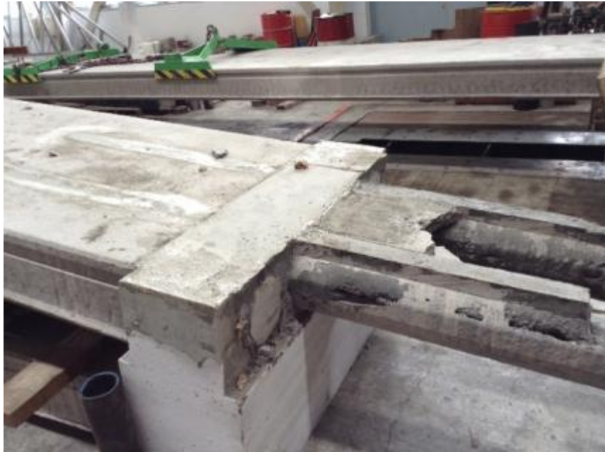
Hasil test koneksi tulangan negatif hollow core
