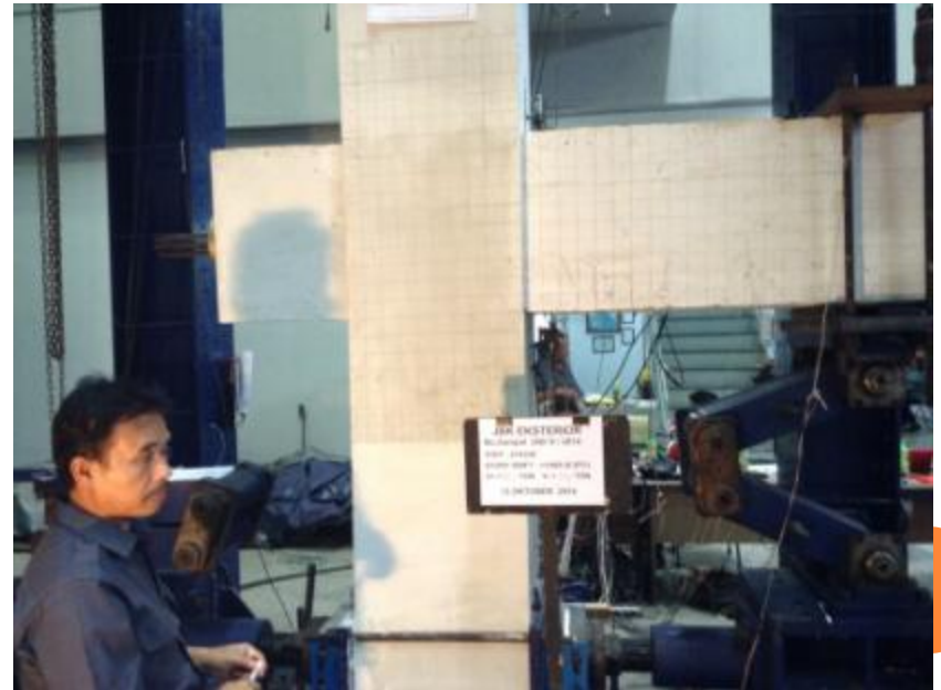
Drift 0.25% P+=8.27 ton P-=7,24 ton
