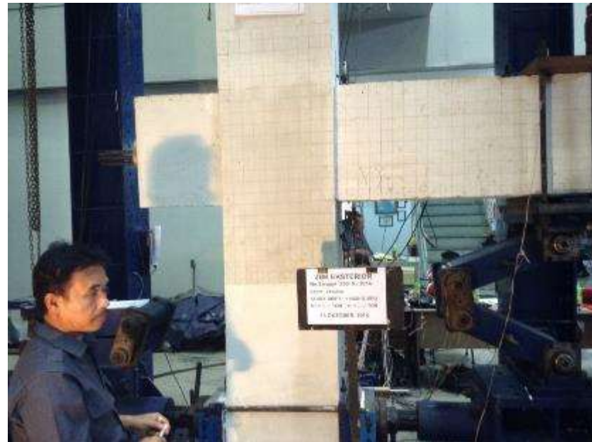
Drift 0.25% P+=8.27 ton P-=7,24 ton
