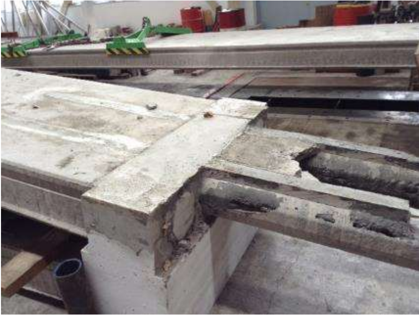
Hasil test koneksi tulangan negatif hollow core
