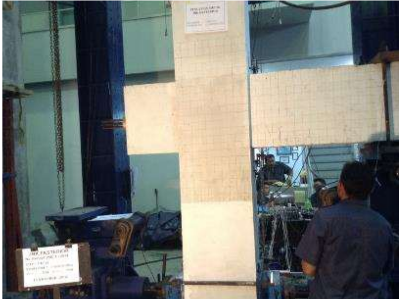
Drift 0.2% P+=7.34 ton P-=6.02 ton
