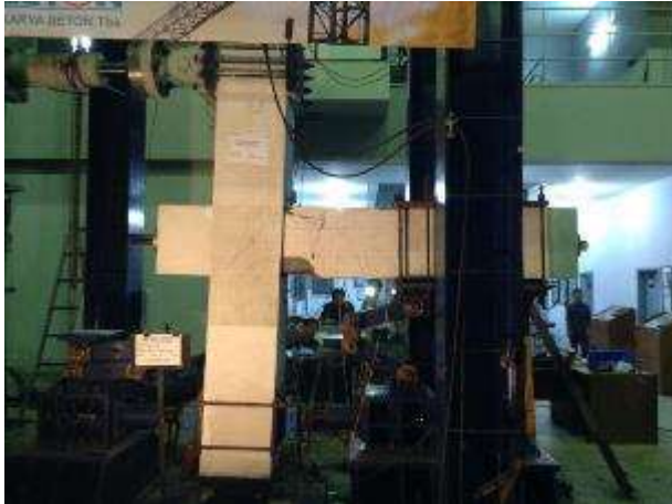
Benda uji pada drift 3.5%
