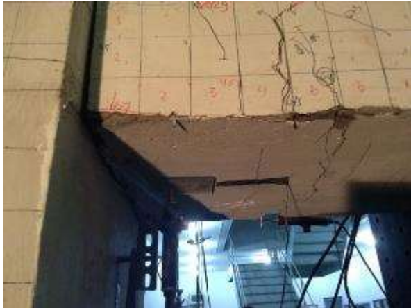
Dissipater bawah membuka dan ada gap di muka kolom
