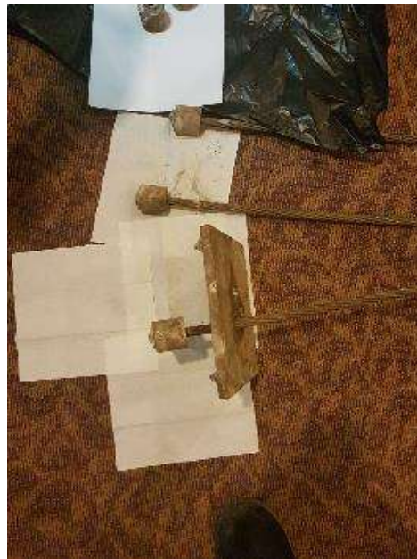
Baji digrouting di barrel
