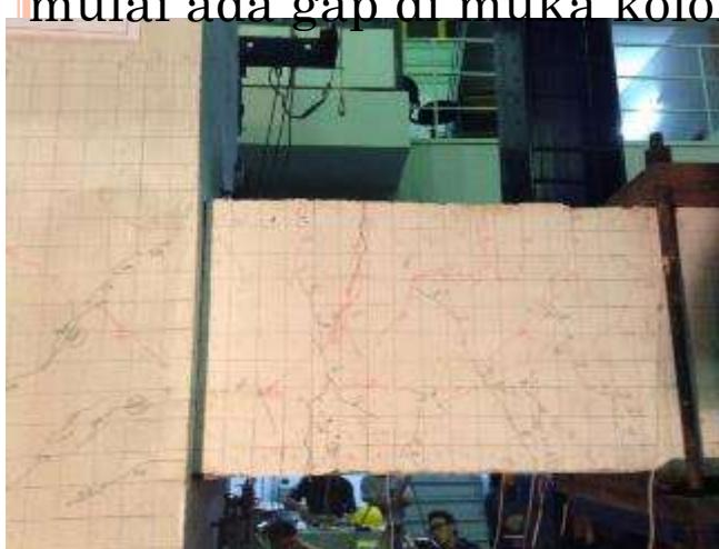
Dissipater atas membuka dan mulai ada gap di muka kolom
