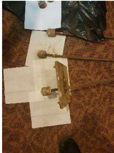
Baji digrouting di barrel
