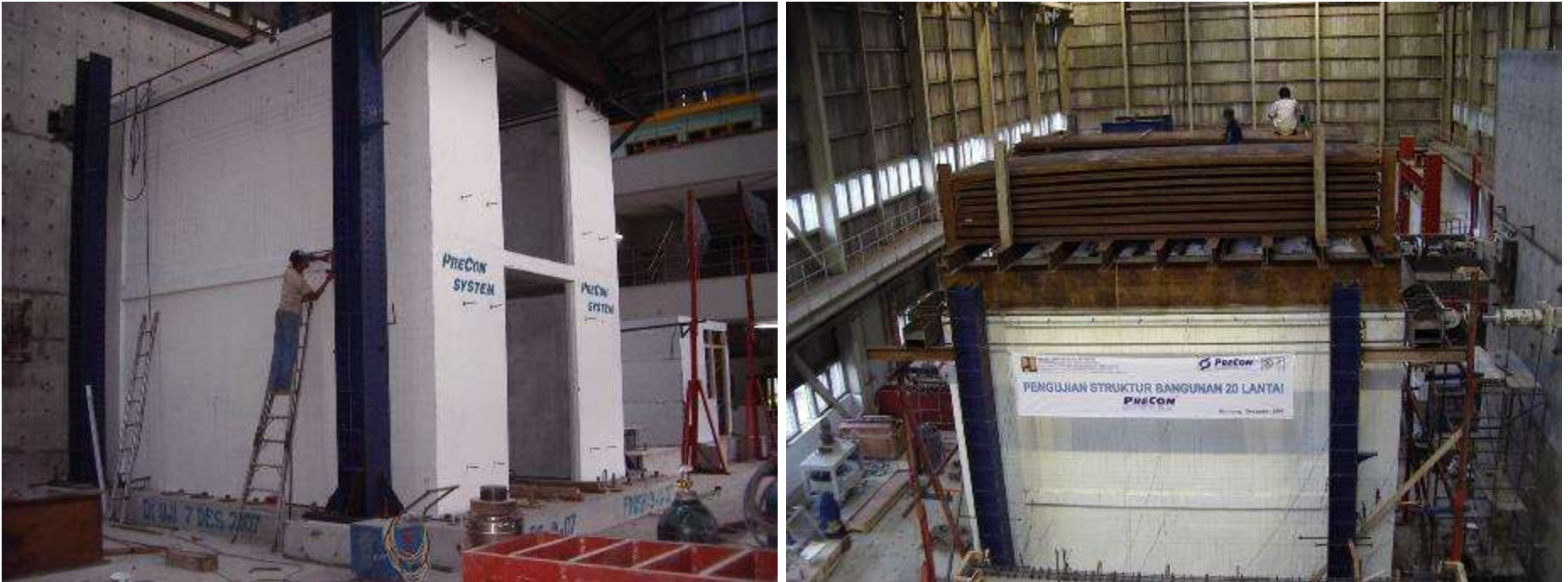
Pengujian Sistem Dinding Penumpu
