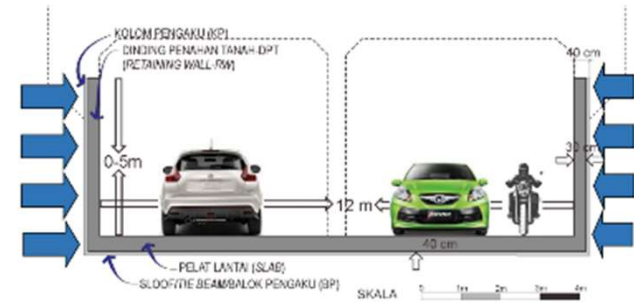
Gambar 9. Penampang konstruksi DPT/RW.
