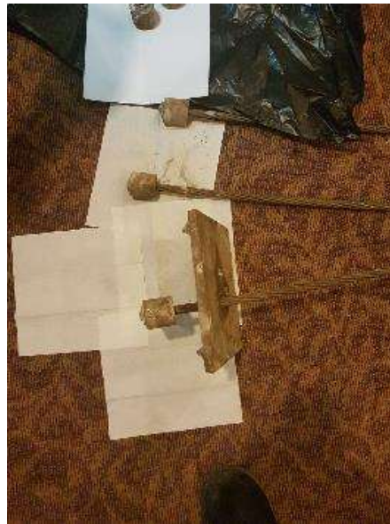
Baji digrouting di barrel
