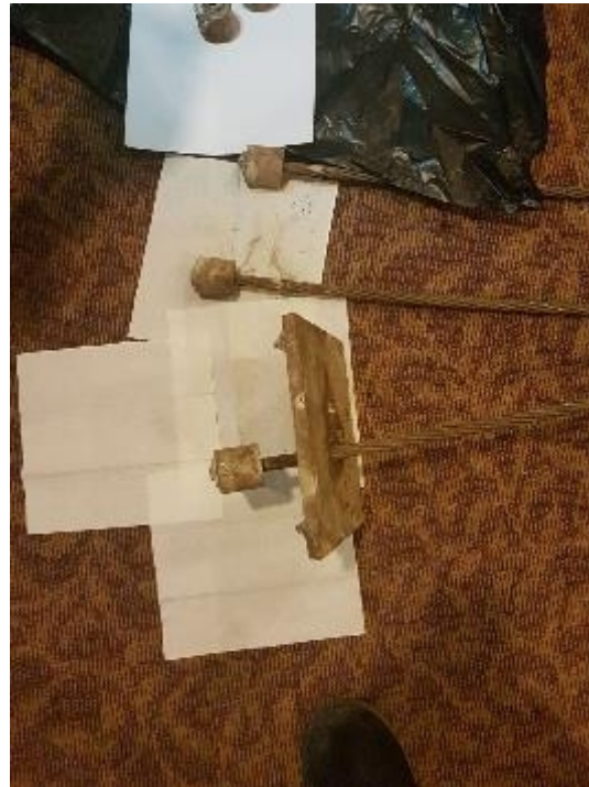
Baji digrouting di barrel
