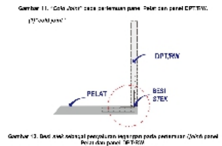
Gambar 11. Cold joint pada pelaksanaan panel Pelat dan panel DPT/RW.
