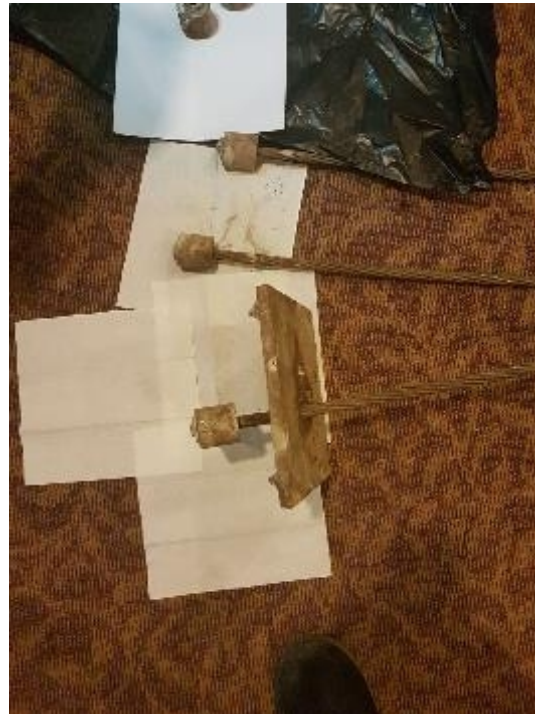
Baji digrouting di barrel
