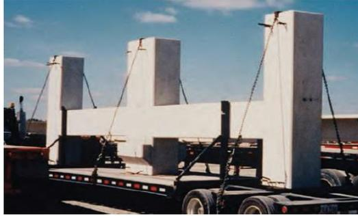
**Gambar 3.1.1- Rangka Momen Pracetak dengan sambungan kolom yang jauh dari joint balok-kolom**
