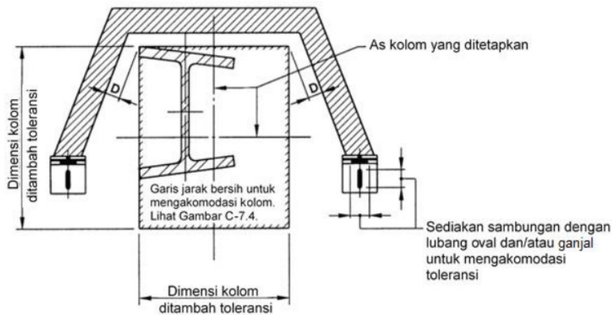
Gambar C-7.2 – Toleransi lokasi kolom dalam denah
