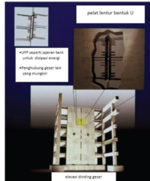
Gambar 5.1b – Struktur uji PRESSS dengan sambungan panel dinding
