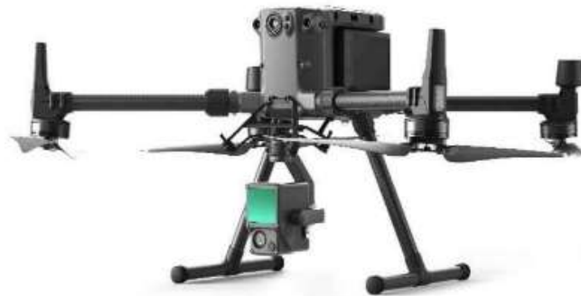
Gambar 5. DJI Zenmuse L1 yang terinstall di wahana drone
